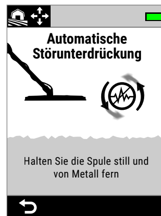
Automatische Störunterdrückung läuft.
